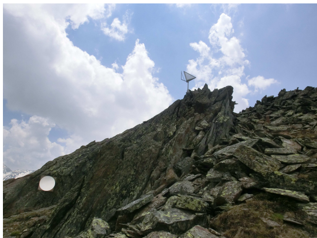
Figura 15: Reference target per il TLS e corner con braccio per la misura GPS
