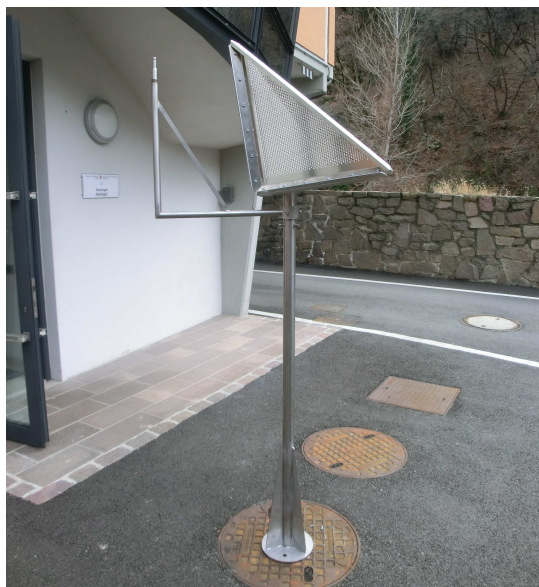
Figura 14: Corner reflector e braccio con innesto a baionetta per la misura GPS
