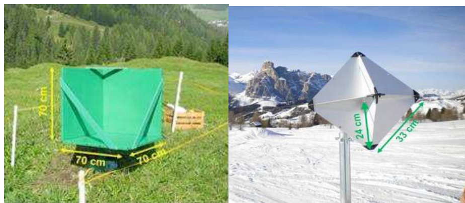
Figura 7: corner reflector artificiali per la Banda C (sx) e Banda-X (dx) (Progetto Lawina).
