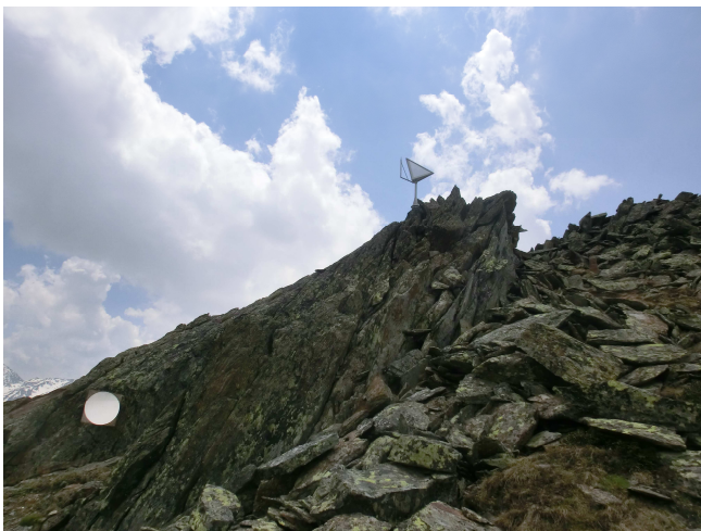
Abbildung 15: Kontrollpunkt für den TLS und Winkelreflektor mit Arm für GPS-Messungen
