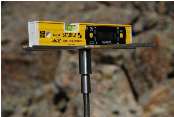
Abbildung 16: Gerät zur Bewertung des rotationalen Anteiles der Verformung
