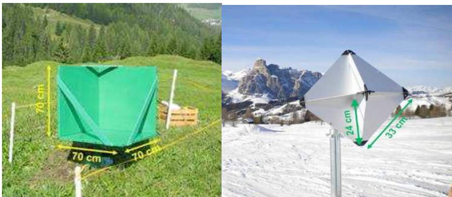
Abbildung 7: künstliche Winkelreflektoren für die C-Band (links) und die X-Band (rechts) (Projekt Lawina).
