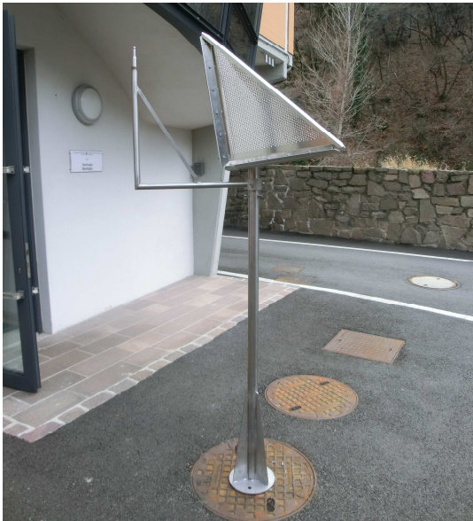
Abbildung 14: Winkelreflektor und Zapfenanschluss für GPS Antenne
