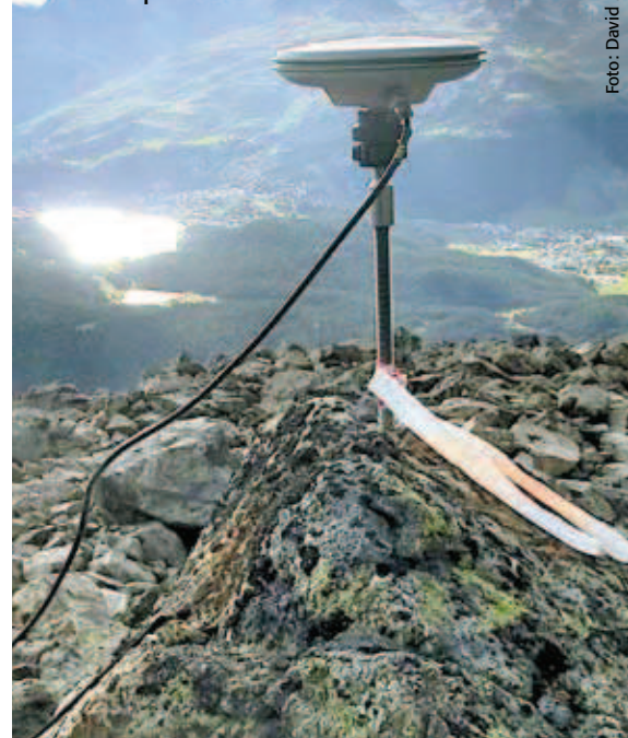
Antenna del GPS utilizzata per i rilevamenti
